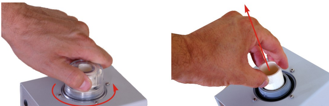
图 53. 更换 MD3 气体干燥机的过滤器的入口
