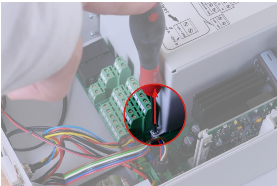
图 46. 金属外壳 - 固定螺丝的位置.
