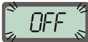
图 59. 虽然额外的通道正在通风, 该设备显示关闭的信息注释和轮流显示最后的测量值
