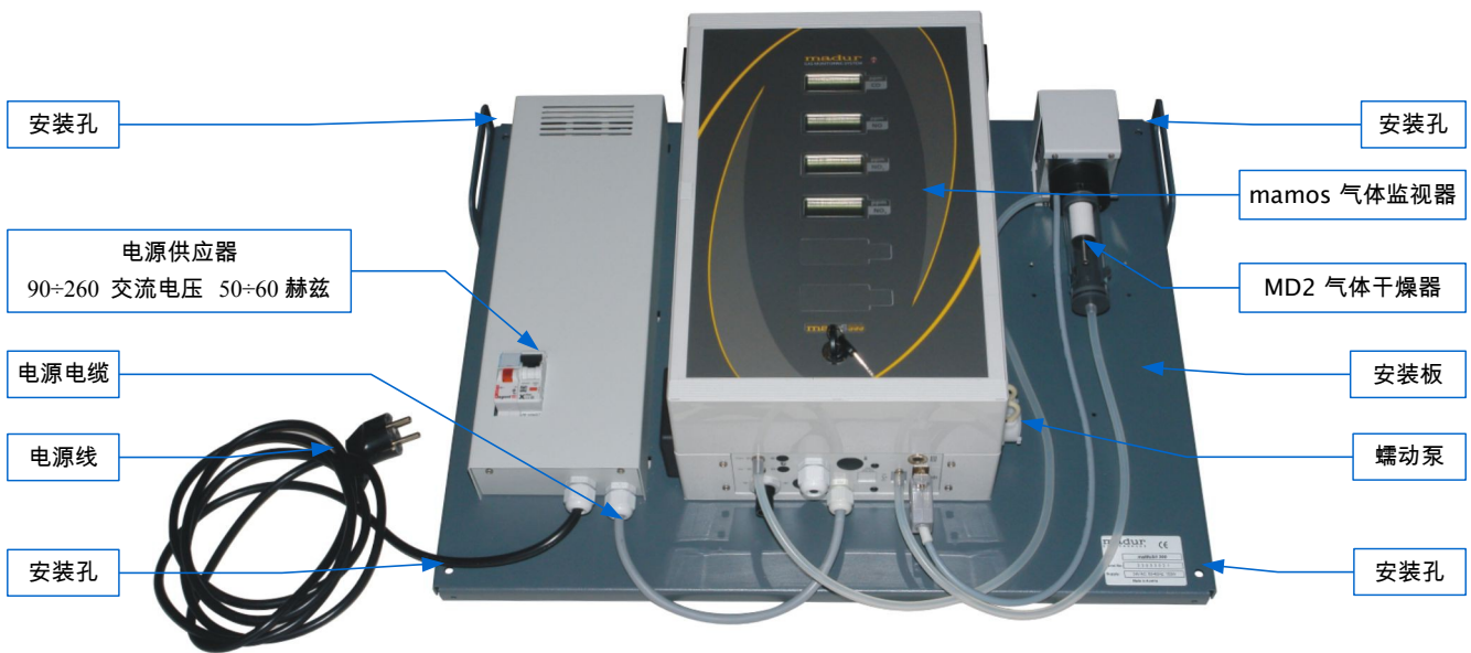
图 4. 完整的 maMoS 400 气体监测仪带有 MD2 气体干燥器和选置电源供应器 部件
