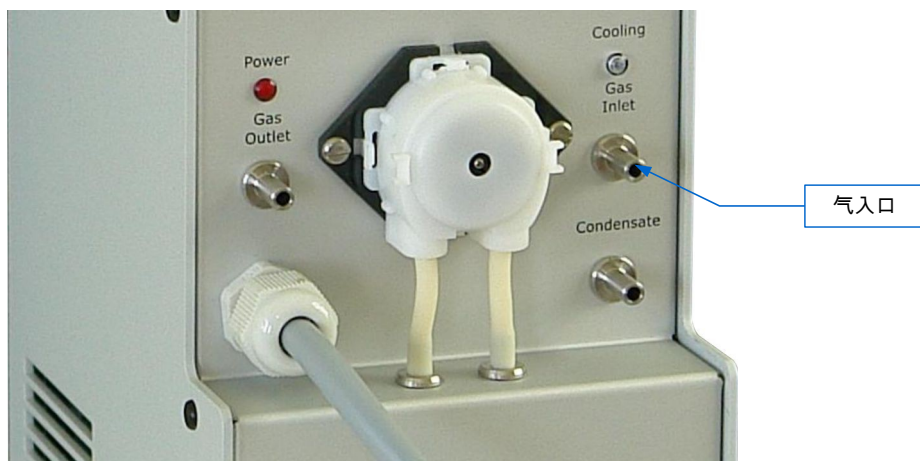
图 25. MD3 气体干燥器里气体采样入口的位置
